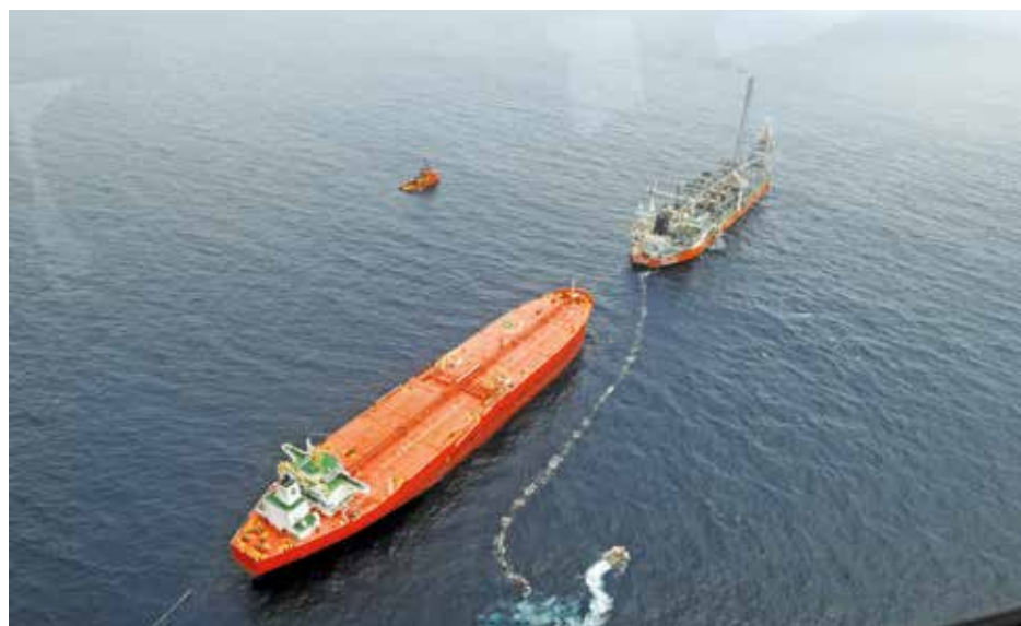
Operação de carregamento de crude em acção no terminal do FPSO PSVM.
