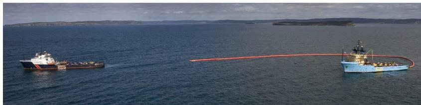
**Figure 15. Barrage NorLense 1200-R – Déploiement de deux navires**
