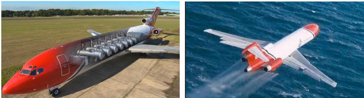
**Figure 16. Système de pulvérisation aérienne de dispersant TERSUS d'OSRL**
