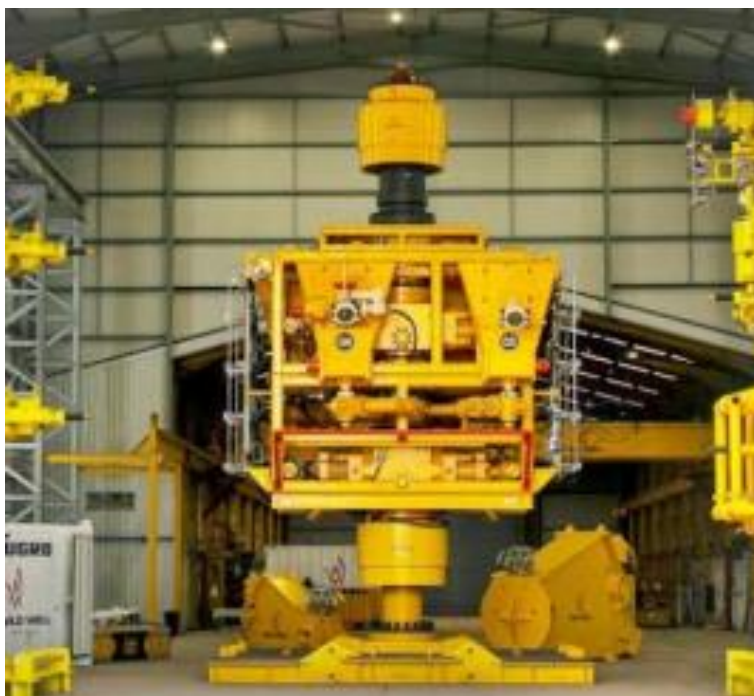
Figure 3 : Colonne de coiffage pour contrôle d'un puits
