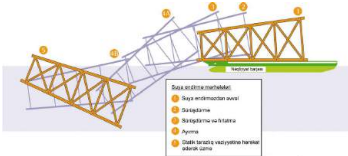
Şəkil 5.12 Dayaq blokunun quraşdırılması
