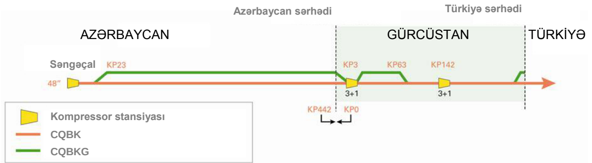
Şəkil 5-1: 48 düymlük CQBKG boru kəmərinin və obyektlərin sxemi
