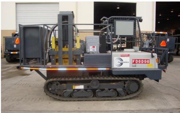
Şəkil E.3: Quru üçün Sinxronlaşdırılmış Elektrik İmpulsiv Mənbə
