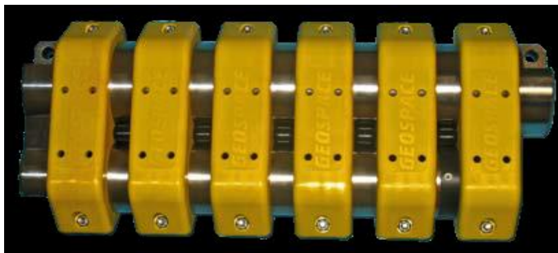
Şəkil4.7: Geospace OBX model dənizdibi qovşağın fotosəkli
