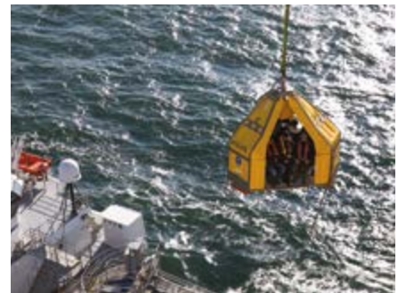
Heyət daşıma səbəti - qabaqçılıq əməyin təhlükəsizliyi xüsusiyyətlərinə malik heyət daşıyıcı cihazdır ki, işçilərimizin gemidən platformaya keçirmək məqsədilə istifadə olunur.
