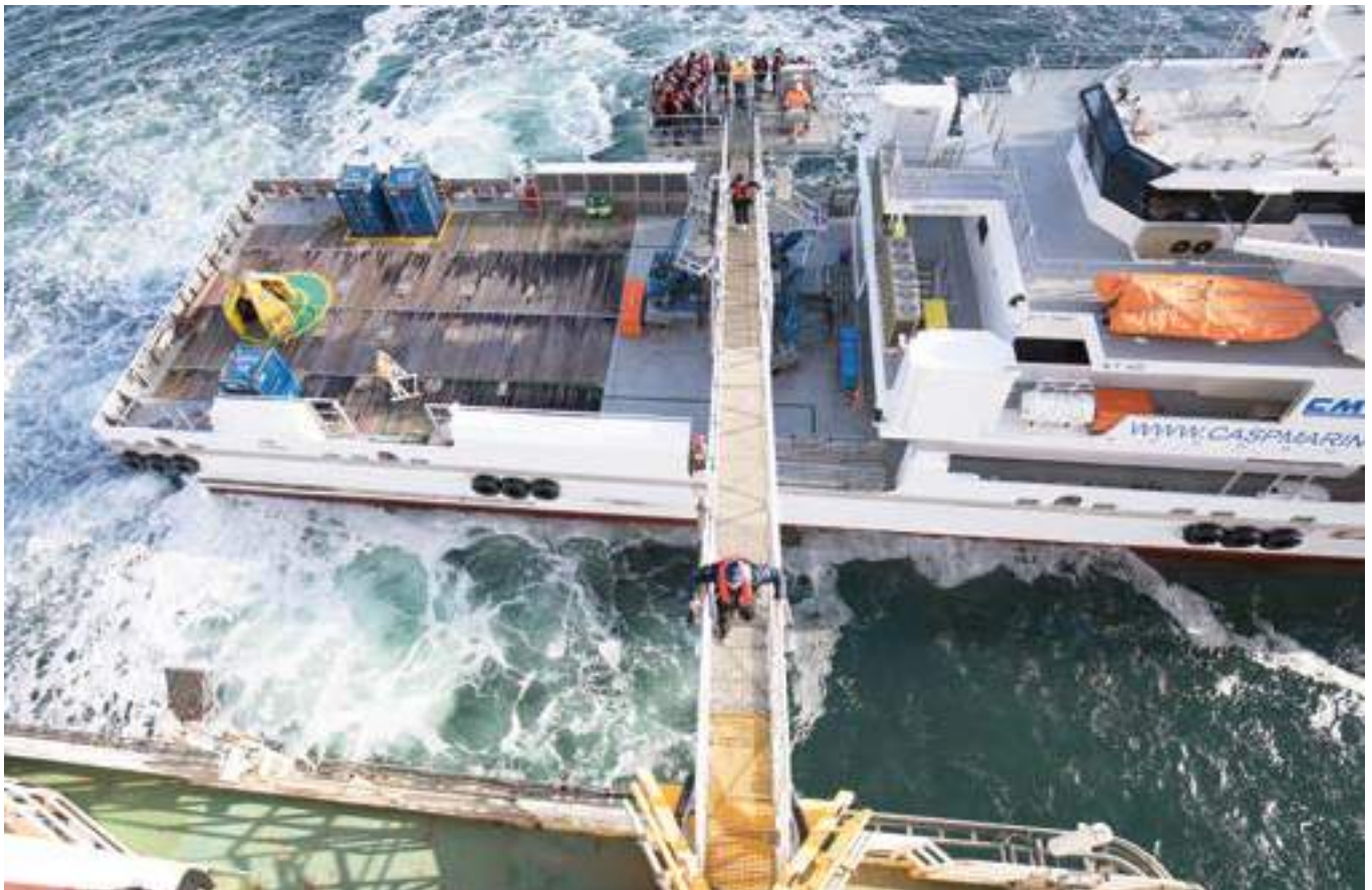
Dənizdəki əməkdaşlarımız işə təhlükəsiz qaydada çatmaq üçün heyətdaşıma gəmisi ilə platformanı birləşdirən “Ampelmann” körpü keçidindən istifadə edirlər.
