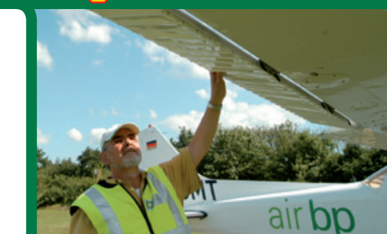
7 Querruder: frei beweglich! Sicherer Anschluß!
