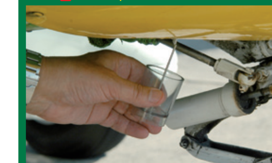
9 Kraftstoffprobe am Vergaser und sonstige Entwässerungspunkte!
