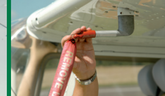
6 Pitotrohr: Abdeckung entfernen!
