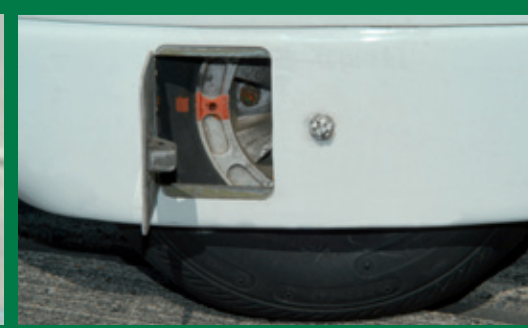
15 An allen Radreifen die Rutschmarken kontrollieren!
