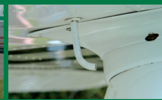
13 Ist die Kraftstofftankentlüftung frei?
