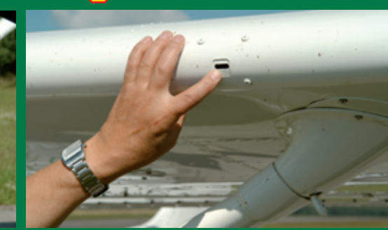
11 Ist die Druckausgleichsöffnung der Überziehwarnung frei?
