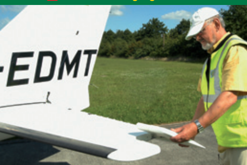
19 Ist das Höhenruder frei beweglich? Sichere Befestigung!
