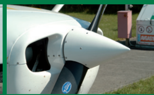
14 Propeller/Spinner: Frei von Kerben? Sichere Befestigung!
