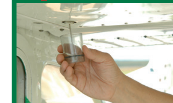
8 Zehn Minuten nach der Betankung: Kraftstoffprobe auf Wasser und Sinkstoffe!
