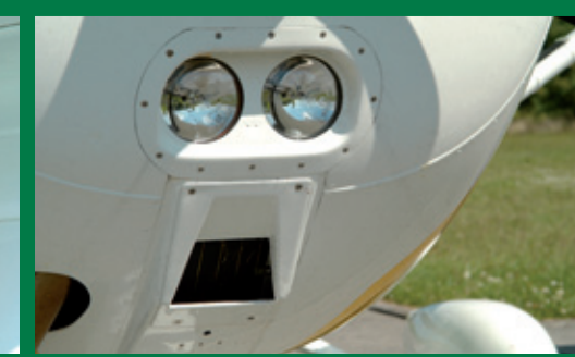
12 Ist der Landescheinwerfer sauber? Vergaserluftfilter: Zustand, Sauberkeit!
