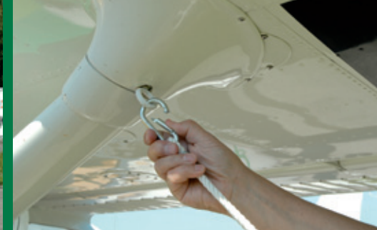
2 Flügel- und Heckverankerung lösen!
