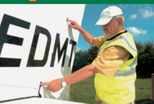
20 Ist das Seitenruder frei beweglich? Sichere Befestigung!
