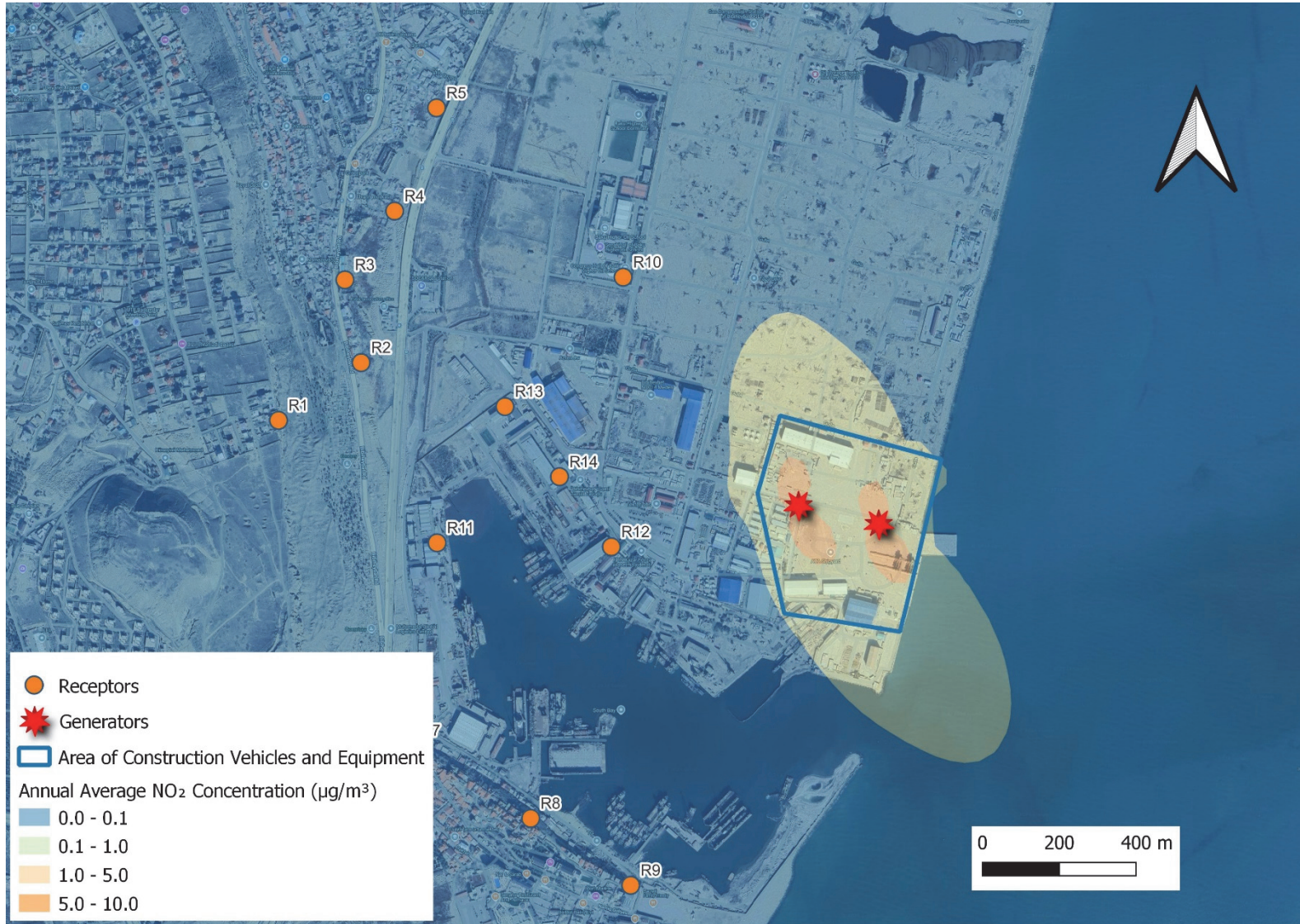
Şəkil D.3: İllik orta NO 2 konsentrasiyaları üzrə konturlu sxem - AzFenin Bayıldakı tikinti-quraşdırma sahəsi (2023-cü ilin meteoroloji məlumat toplusundan istifadə edilib)
