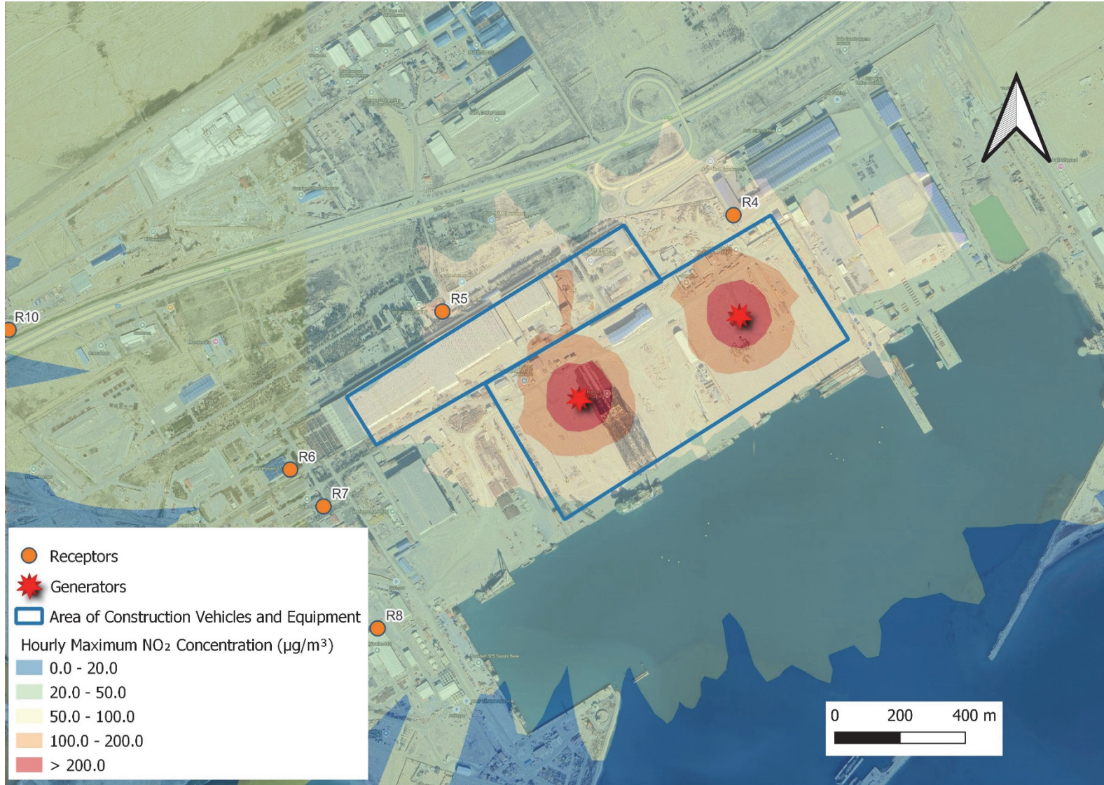
Şəkil D.2: Saatlıq maksimum NO 2 konsentrasiyaları üzrə konturlu sxem - BDÖZ sahəsi (2021-ci ilin meteoroloji məlumat toplusundan istifadə edilib)
