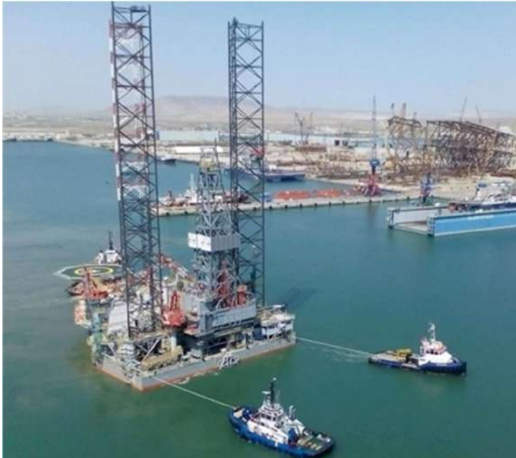
Şəkil 2.2: Tipik özüqalxan qazma qurğusu
