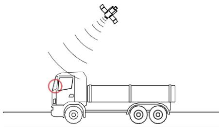
Nelle tratte stradali dove è invece attivo il servizio satellitare, il transito del veicolo in zone soggette a pedaggio è rilevato dal GNSS. Il dispositivo è attivo solo quando è correttamente installato e il quadro strumenti è acceso. Comunica con il conducente attraverso segnali acustici, segnali luminosi (LED) e messaggi vocali. Il conducente può accedere alle funzioni del dispositivo sia attraverso l'App Telepass Truck, sia agendo direttamente sul dispositivo.
