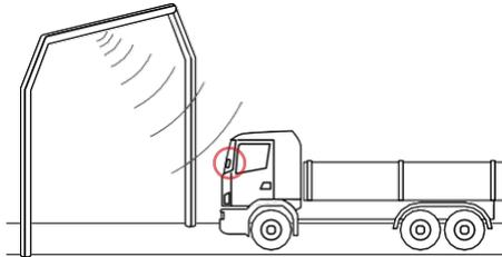
Nelle tratte stradali dove è utilizzato il sistema radio, il rilevamento avviene tramite antenne posizionate nelle corsie dedicate o, dove è disponibile il servizio free-flow, su portali localizzati lungo la rete stradale. Durante il transito sotto i portali, il corretto funzionamento del dispositivo è indicato da segnali acustici e/o avvisi sul display.
