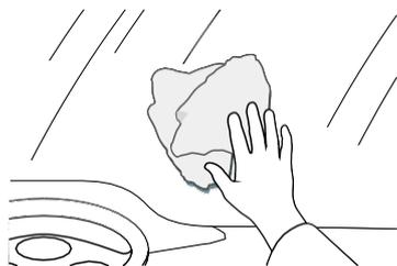
1. Pulire con cura la zona di applicazione sul parabrezza con un detergente multiuso.
