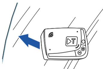
3. Posizionare il dispositivo orizzontalmente sul parabrezza ben pulito.
