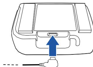
1. Verificare che il connettore sia saldamente inserito nella presa di alimentazione.
