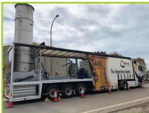
Foto vehículo tratamiento circuito cerrado de gases de limpieza de tanques
