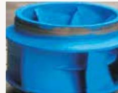
Revestimento de rotor de bomba
